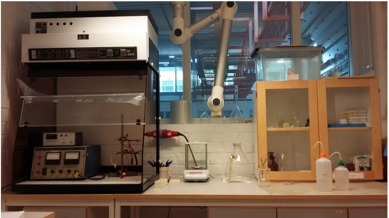
Рисунок 13. Рабочее место с установкой для проведения электролитического растворения.
