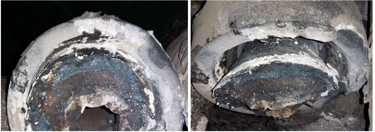
Рисунок 6. Заросший сталеразливочный стакан.
